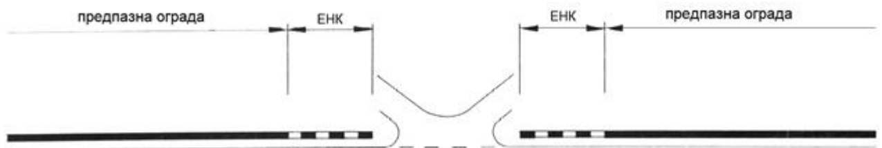
Фигура 9б Прекъсване на ограничителна система за пътища с елементи за начало и край
