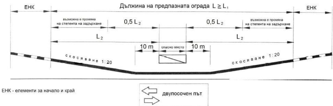
Фигура 6. Минимална дължина на ограничителна система за пътища изпълнена чрез двустранно скосяване преди и след опасно място при двупосочен път
