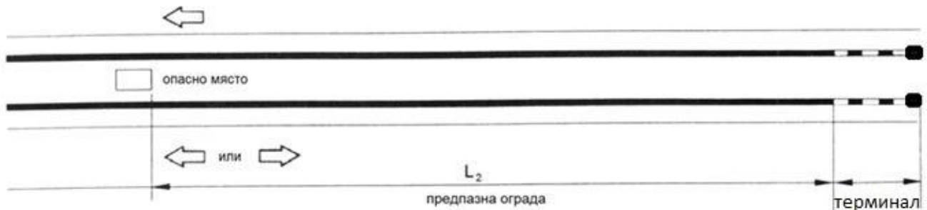
Фигура 21. Ограничителна система изградена двустранно в разделителна ивица от едностранна ограничителна система за пътища с единични терминали за начало
