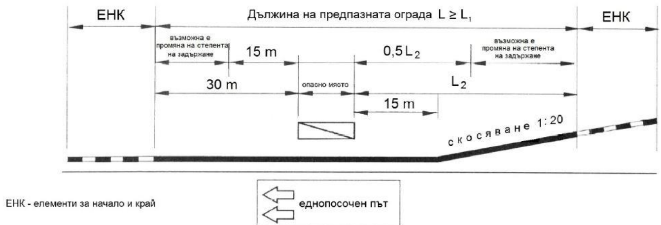
Фигура 7. Минимална дължина на предпазната ограда при едностранно скосяване пред опасно място при еднопосочен път
