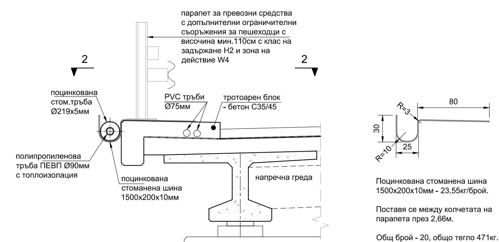
ДЕТАЙЛ "С" - проектно положение на водопровода (постоянно фиксиране на тръбата)
